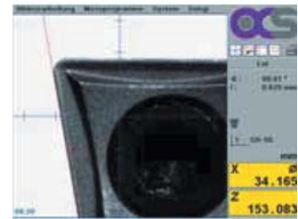
6) Aufsicht für die Schneideninspektion
